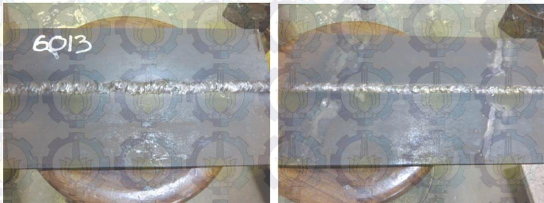
**Gambar 3.11.** Hasil pengelasan bawah air dengan elektroda E6013
