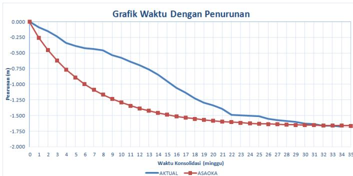
**Gambar 5.10** Kurva pemampatan vs waktu dengan metode asaoka pada titik SP-01
