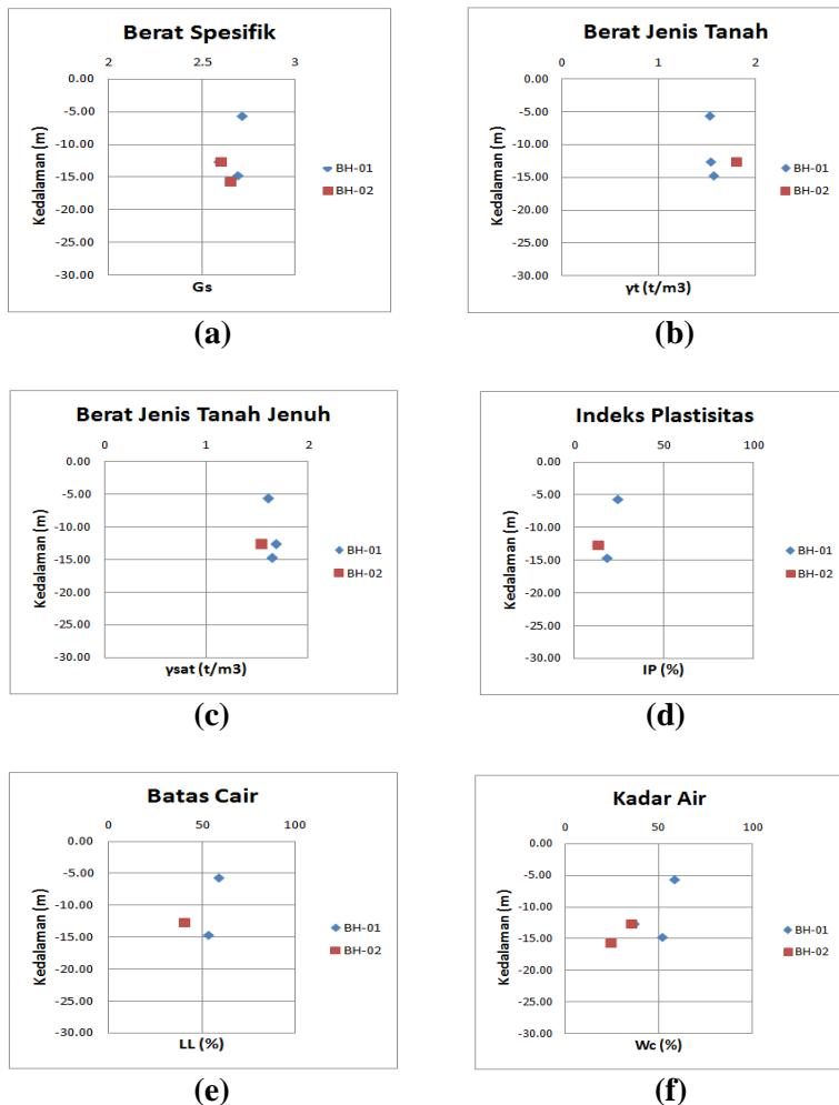
**Gambar 4.3** Plot data parameter tanah (a) Berat spesifik butiran padat, (b) Berat jenis tanah, (c) Berat jenis tanah jenuh, (d) Indeks plastisitas, (e) Batas cair, (f) Kadar air
