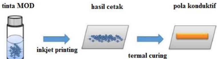
Gambar 2. 2 Prinsip Kerja Tinta Konduktif MOD
