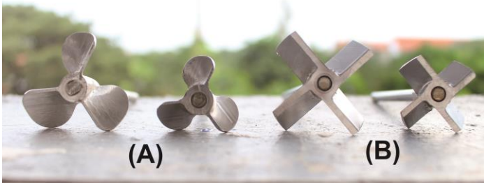
Gambar 3.2 Jenis impeller yang digunakan (A) 3-blade propeller diameter 4 cm, 3 cm dan (B) 4-blade inclined blade turbine diameter 4 cm, 3 cm
