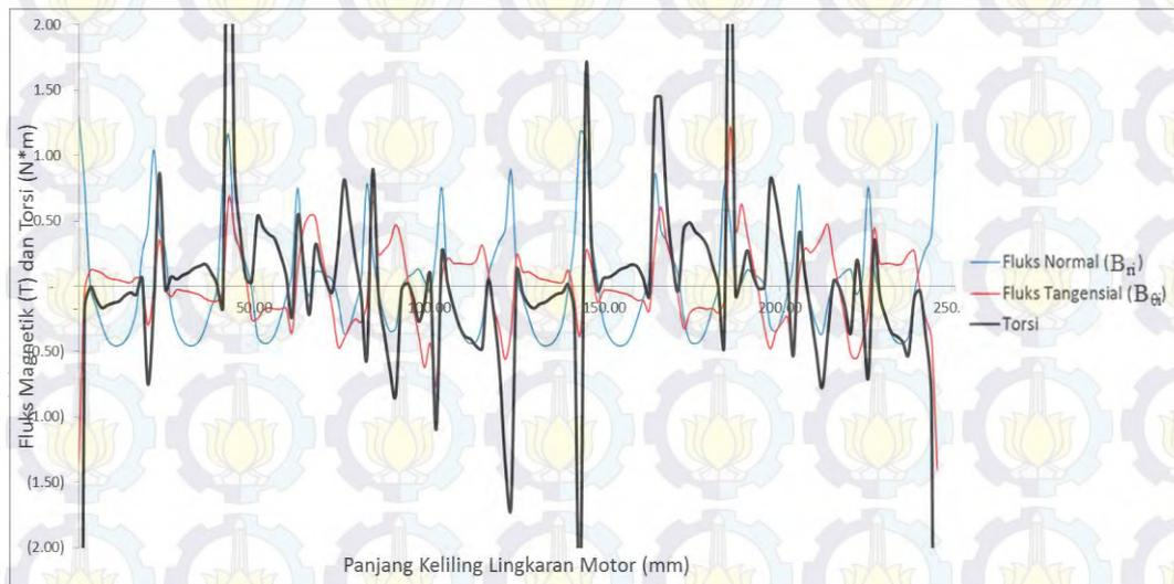
Gambar 4.31 Hubungan antara Fluks Magnetik dan Torsi yang dihasilkan pada motor SMPM
