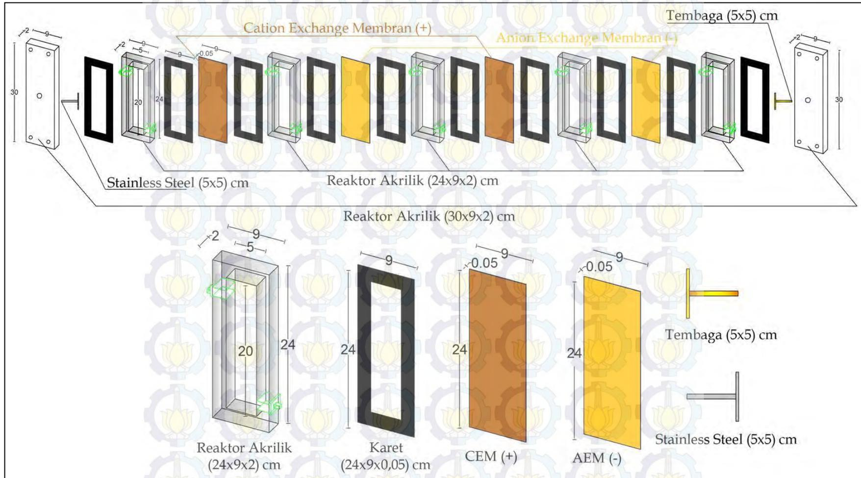
Gambar 3.3 Pemasangan Reaktor ED
