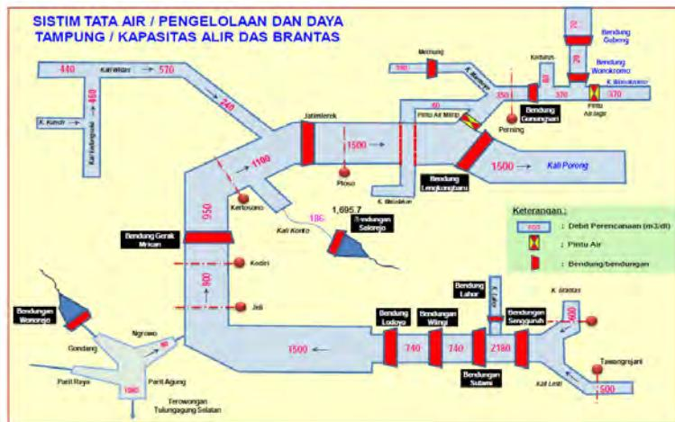
Gambar 2.2 Skematisasi sistem tata air pada WS Brantas
