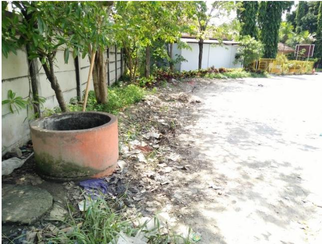
Gambar 4. Sumur Monitoring Kantor, Salah satu sumur yang dilakukan pengukuran untuk menentukan elevasi muka air tanah
