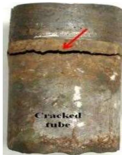
Gambar 2.4 Korosi Tegangan (Hakim, 2011)
