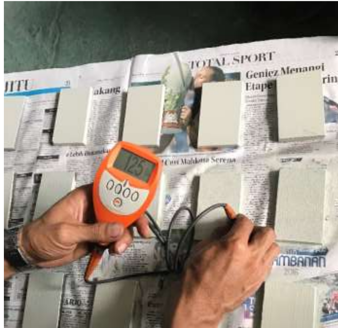
Gambar 3.8 Proses pengukuran DFT
