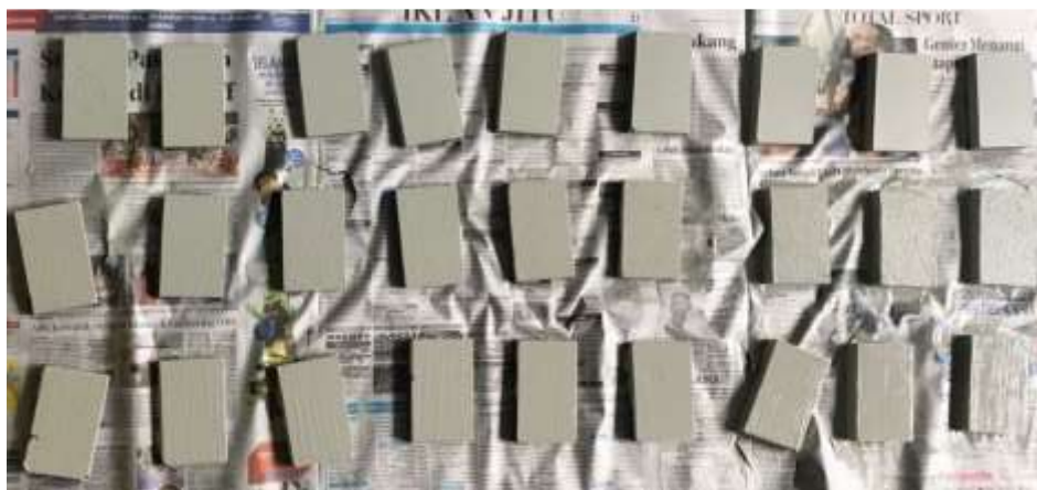
Gambar 4.3 Material yang di coating menggunakan cat primer.
