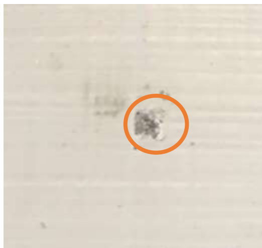
Gambar 4.10 Cacat permukaan spesimen yang dilapisi coating akibat uji Impact .
