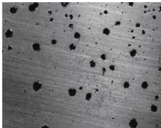
Gambar 2.7 Korosi Sumur (Budi Utomo, 2009)
