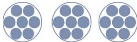
Gambar 9. 2.PC Strand dari Freyssinet dengan 7 wire stress, diameter 12,7mm (0.5") ASTM A 416-90a
