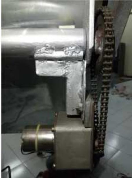
**Gambar 3.2** Motor DC dan Gear Box
