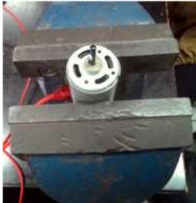
**Gambar 4.10** Motor DC diletakkan pada penjepit
