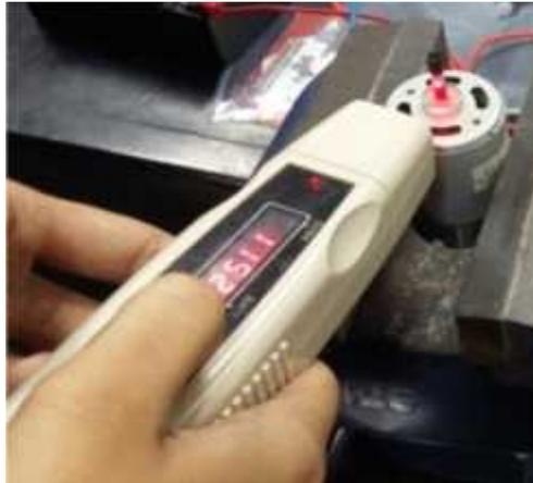
**Gambar 4.13** Pengambilan data menggunakan *Tachometer*
