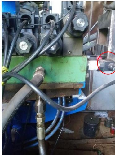
**Gambar 4.1** Penempatan Sensor *Pressure Transmitter*
