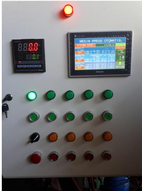
**Gambar 3.5.** HMI LPS-070 pada *control panel*
