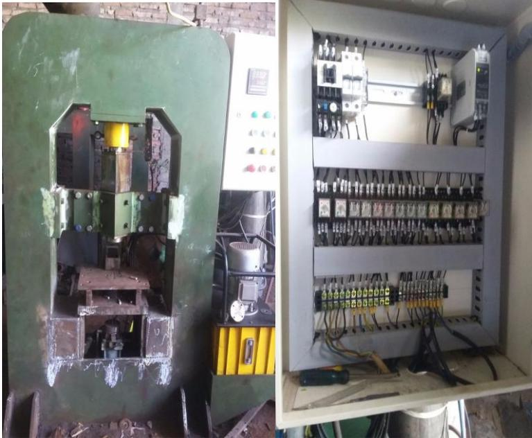
monitoring di HMI dan pressure gauge,penekanan akan dilakukan oleh piston 1 hingga mencapai set point oleh karena kerja pompa hidrolik dan akan berhenti menekan ketika set point tercapai. Motor pompa hidrolik akan mati secara otomatis ketika terjadi trip.
