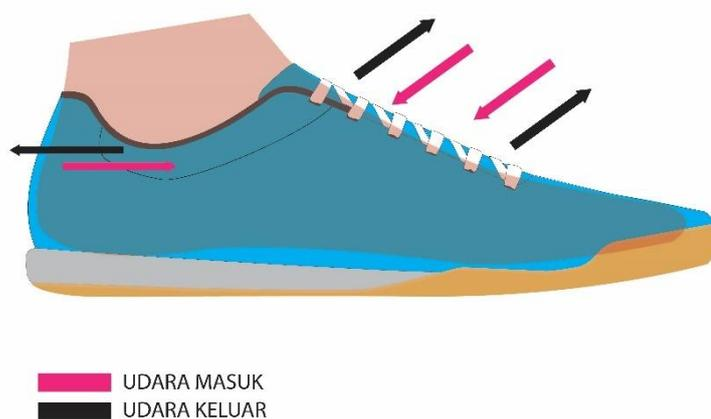
Gambar 4. 18 Analisa sirkulasi udara pada sepatu
