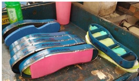
gambar 0.33 *Cutting dies* yang digunakan memotong lembaran EVA untuk menjadi *insole*
