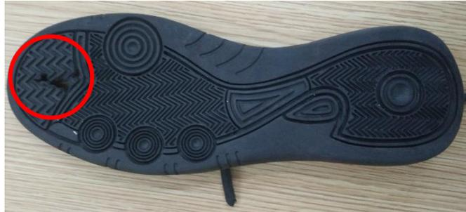
Gambar 6. 5 Sol Sepatu Lubang
