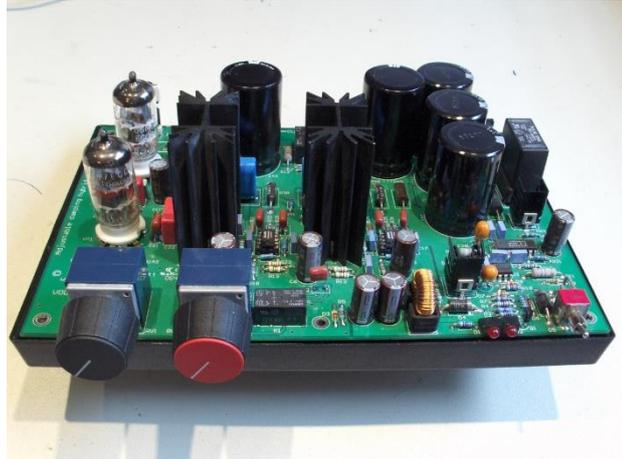
Gambar 2. 17 Amplifier Hybrid Komponen
