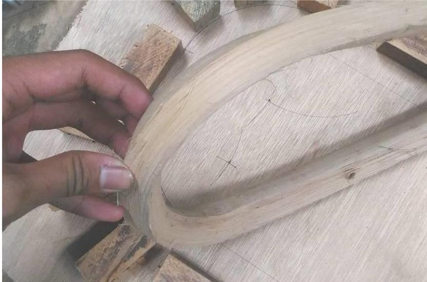
Gambar 4. 27 Hasil Bending Rotan Yang Cacat
