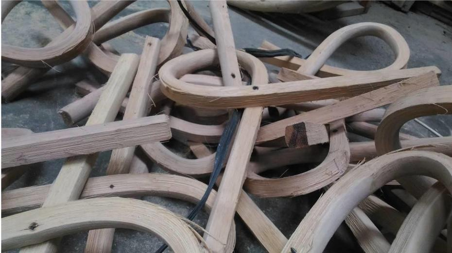
Gambar 4. 23 Hasil Akhir Rotan Sebelum di Assembli
