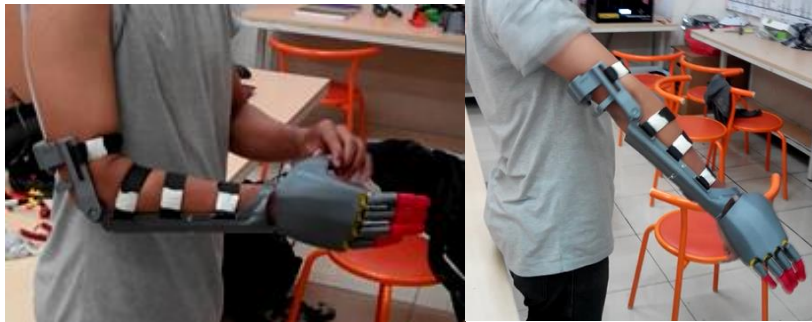
Gambar 2. 18 protesis open source untuk tuna daksa bawah siku
