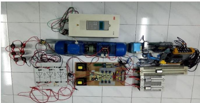
**Gambar 4.1.** Alat Pengujian *Z-Source Inverter*
