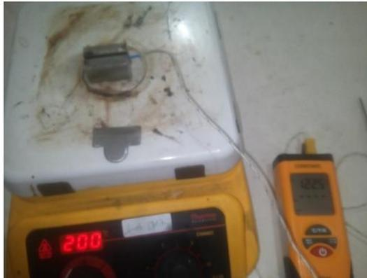
Gambar 3.13 Proses pemanasan cetakan dengan hotplate
