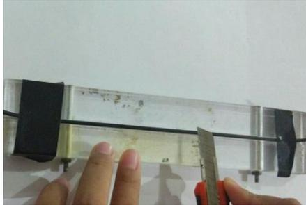
Gambar 3.3 Pengupasan coating serat optik. Setelah dikupas coatingnya dapat dilihat apakah ada cahaya yang bocor atau tidak dengan memberikan sumber cahaya pada salah satu ujung serat optik, seperti ditunjukkan pada gambar 3.4.
