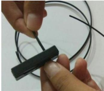
Gambar 3.2 Pemotongan serat optik
