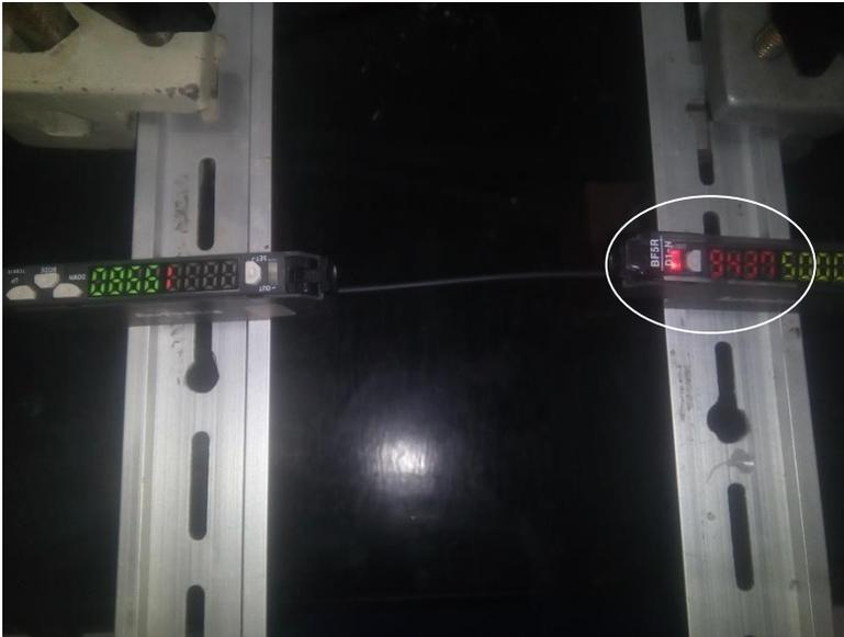
Gambar 4.4 Display intensitas cahaya input dengan *mode long* menggunakan BF5R-D1-N
