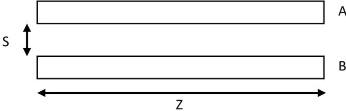
Gambar 2.8 Susunan kanal dalam *directional coupler*
