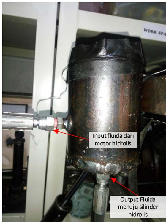
Gambar 4.12. Reservoir tank yang digunakan dalam implementasi HMERSA.
