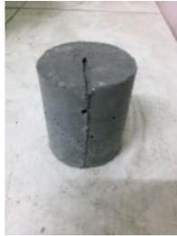
Gambar 4.6 Spesimen Pengujian Konduktifitas Panas
