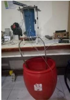
Gambar 3.4. Alat Uji Konduktifitas Panas [Laboratorium Perpindahan Panas Departemen Teknik Mesin Institut Teknologi Sepuluh Nopember Surabaya]
