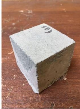
Gambar 4.4. Spesimen Cold Crushing Strength
