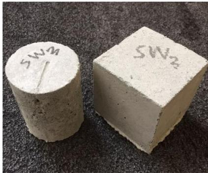
Gambar 3.1. Spesimen Refraktori Castable
