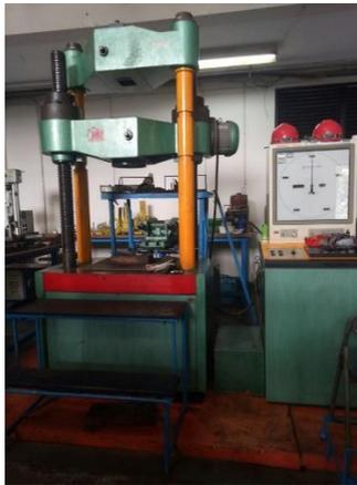
Gambar 3.3. Alat Uji *Cold Crushing Strength* [Laboratorium Metallurgi Departemen Teknik Mesin Institut Teknologi Sepuluh Nopember Surabaya]
