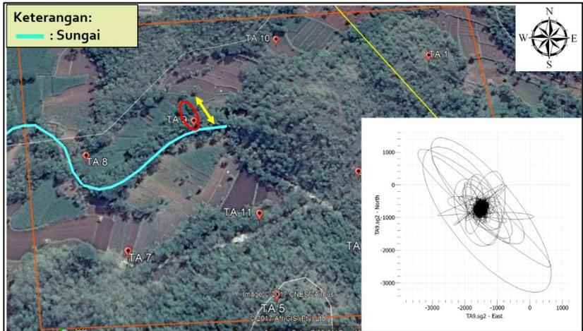
Gambar 4.5 Resultan *particle motion* pada titik TA9
