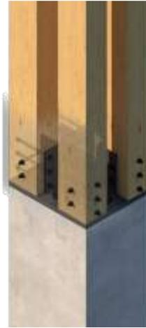
*Gambar 4.5 Detail Sambungan Kolom Kayu dengan Beton
