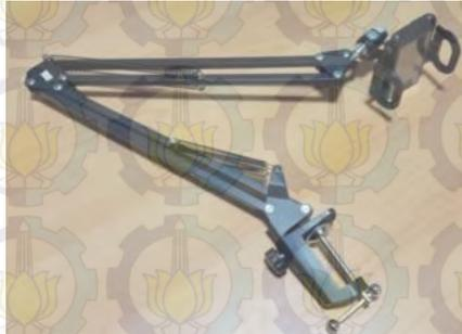
**Gambar 3.25** Lengan Raspberry Pi Model B+ beserta modul kamera
