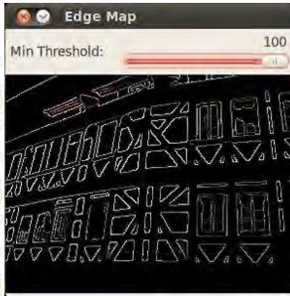
**Gambar 2.22** Contoh hasil proses pendeteksian tepian Canny<sup>[20]</sup>
