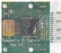
**Gambar 3.22** Modul kamera Raspberry Pi
