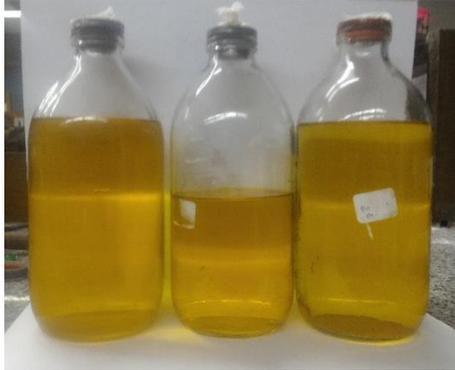
Gambar 4.4 Hidrokarbon tahap I hasil perengkahan termal plastik PP
