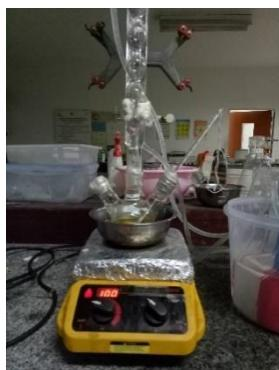
Gambar 4.18 Rangkaian refluks esterifikasi asam oleat
