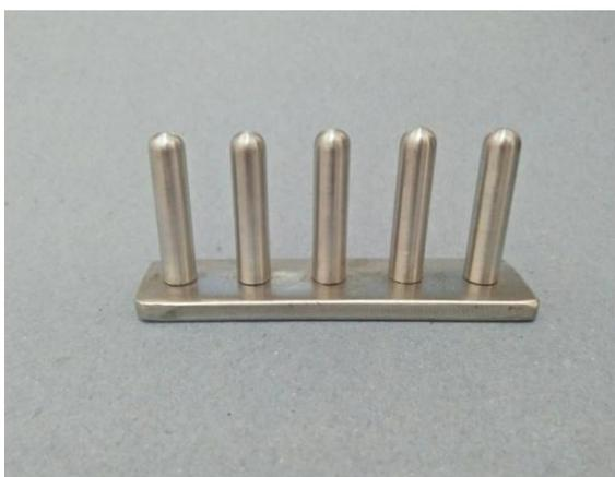
Gambar 4.15 *Pinbar* alat pencetak *hard capsule*
