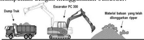
Gambar 5.43 Ilustrasi Pekerjaan Pengangkutan Timbunan Batu
