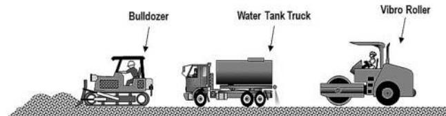
Gambar 5.40 Ilustrasi Pekerjaan Pematatan Timbunan Random
