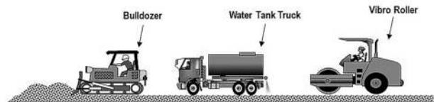
Gambar 5.29 Ilustrasi pekerjaan pemadatan material timbunan random
