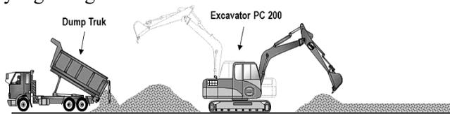
Gambar 5.36 Ilustrasi Pekerjaan Penghamparan Timbunan Filter
