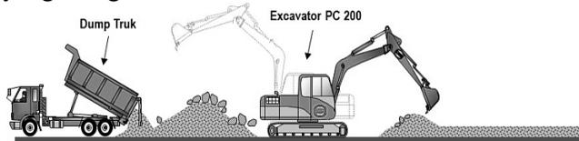
Gambar 5.44 Ilustrasi Pekerjaan Penghamparan Timbunan Batu
