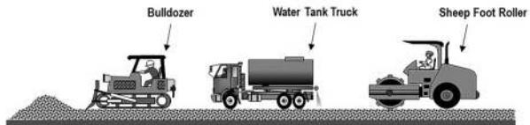
Gambar 5.27 Ilustrasi pekerjaan pemadatan material inti
