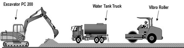
Gambar 5.45 Ilustrasi Pekerjaan Pematatan Timbunan Batu
