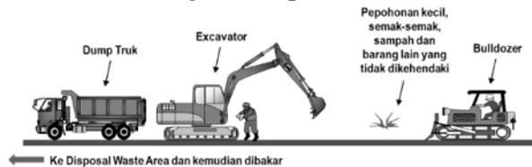
Gambar 5.12 Ilustrasi pekerjaan *clearing and grubbing*
