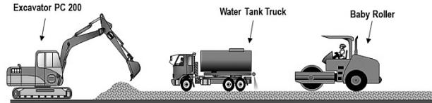
Gambar 5.37 Ilustrasi Pekerjaan Pemadatan Timbunan Filter
