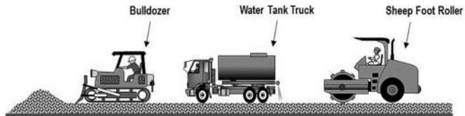
Gambar 5.34 Ilustrasi Pekerjaan Pemasatan Timbunan Inti
