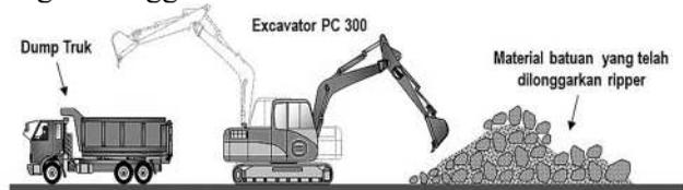
Gambar 5.48 Ilustrasi Pekerjaan Pengangkutan Material Timbunan Rip-rap
