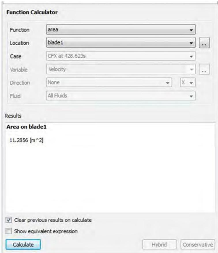
Gambar 4.11 hasil perhitungan luas turbine
