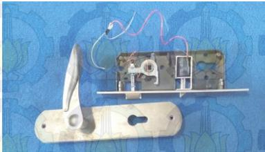
**Gambar 3.3** Desain Solenoid Doorlock dan Handle Pintu
