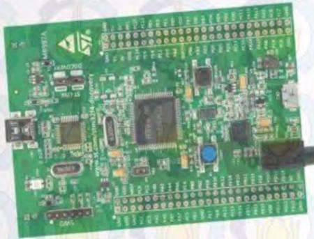
Gambar 2.8 Mikrokontroler ARM
