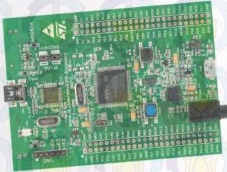
Gambar 2.8 Mikrokontroler ARM
