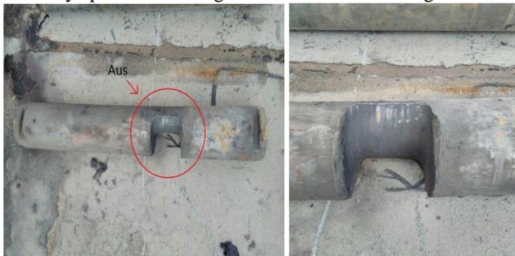
**Gambar 4.1** Material *Axle Shaft* yang mengalami keausan (AISI 1045)
