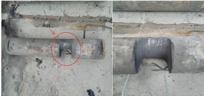
**Gambar 3.2** Material *Axle Shaft* yang mengalami keausan (AISI 1045)
