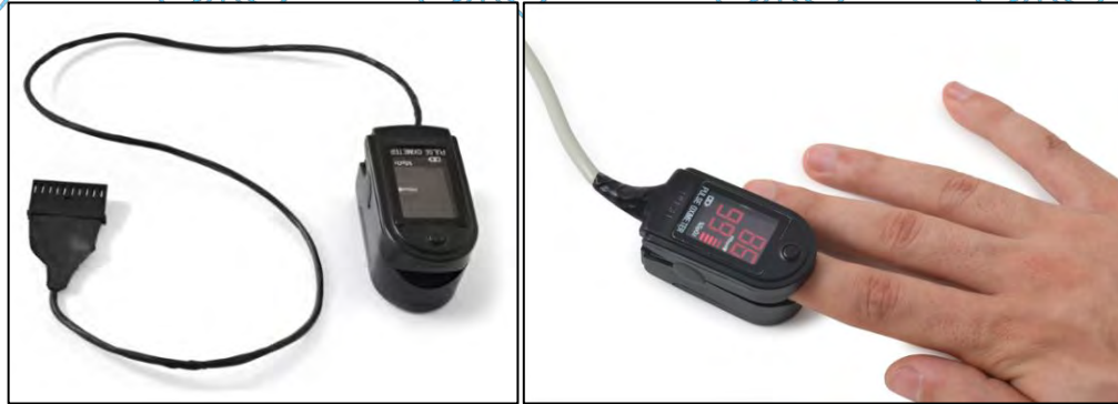
Gambar 2.4. Sensor Pulse oximeter Cooking Hacks dan cara pemasangan pada jari tangan [41]
