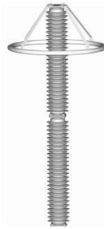
**Gambar 4.6** Contoh desain tipe sangkar pelindung tegangan lebih jenis *metal oxyde*[10]
