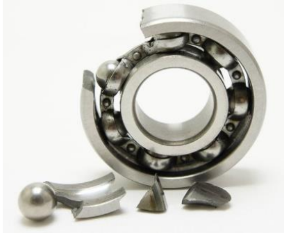
Gambar 2. 4 Kerusakan pada Bearing
