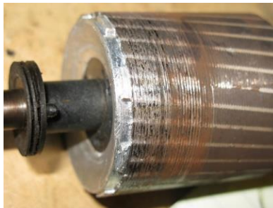
Gambar 2. 5 Kerusakan pada Rotor
