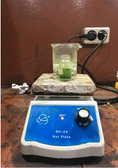
**Gambar D.5** Penguapan Pelarut Menggunakan Heater
