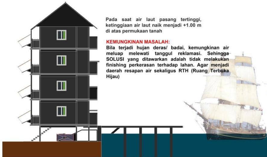
Gambar 4.2.1.1 Potongan Site dan Bangunan saat Kondisi Air Laut Pasang Tertinggi Sumber: Hasil Olahan Pribadi, 2018
