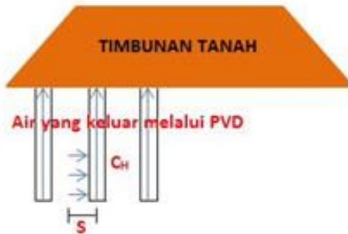
Gambar 2.10 Konsolidasi dengan menggunakan PVD
