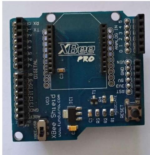
**Gambar 2.5 XBee Shield Pabrikannya Funduino**
