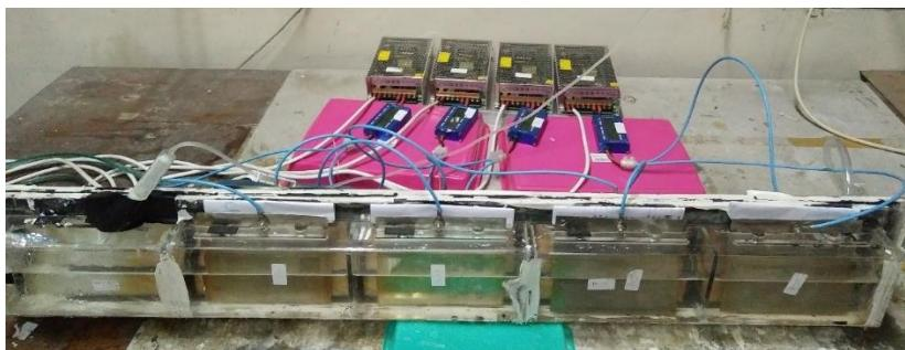
**Gambar 3.** Unit Regenerasi dengan *Membrane Electrolysis*
