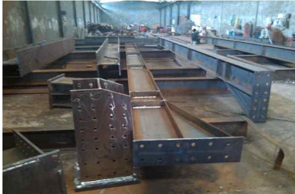
Gambar 9.9 Proses Pabrikasi Baja
