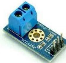
**Gambar 2.9** Modul Sensor Tegangan
