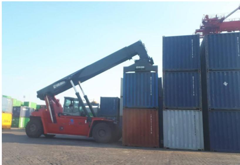
Gambar 4-9 *Reach stacker* pada lapangan penumpukan TPKB
