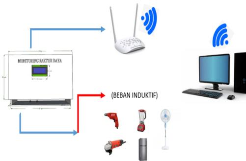
**Gambar 4.24.** Skema Pengujian Alat dengan Beban Induktif
