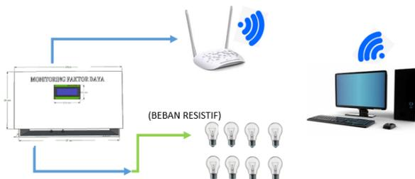
**Gambar 4.23.** Skema Pengujian Alat dengan Beban Resistif
