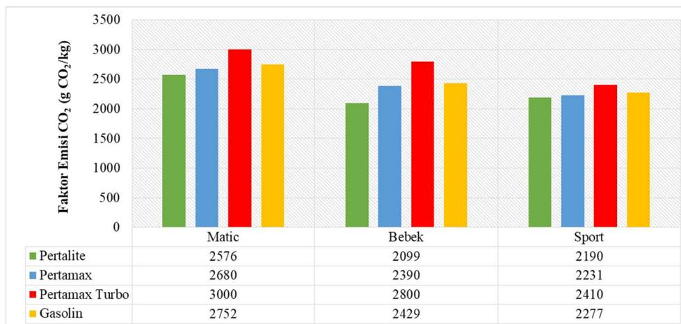
**Gambar 4.19 Faktor Emisi CO<sub>2</sub> Berdasarkan Tipe Kendaraan (g CO<sub>2</sub>/kg)**
