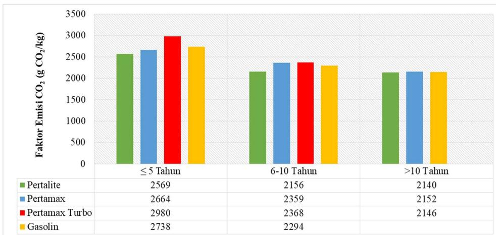
**Gambar 4.16 Faktor Emisi CO<sub>2</sub> Umur Kendaraan (g CO<sub>2</sub>/kg)**
