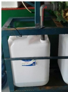
Gambar 3. 13. Tangki air laut sisi masukan pompa
