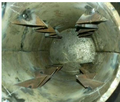
Gambar Pemasangan Vortex Generator Tube
