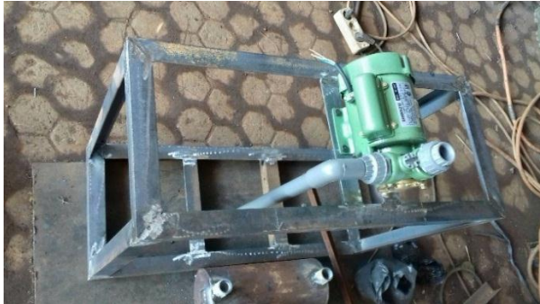
Gambar Perakitan Rangka prototipe dan Pompa
