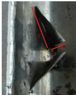
Gambar 6. 1. Perbandingan ukuran delta winglet
