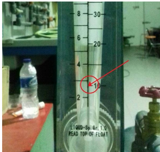
Gambar 3. 16. Alat ukur kapasitas air keluaran pompa
