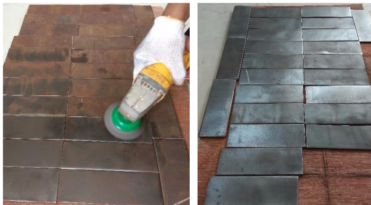
Gambar 3. 13 Treatment Penghilangan Karat pada Face Plate
