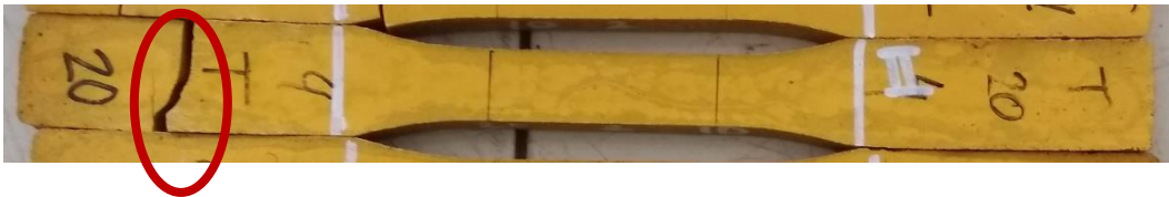
Gambar 4. 7 Patahan Terjadi Pada Ujung Spesimen
