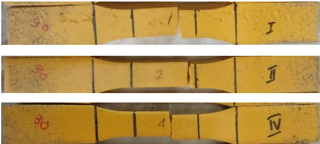
Gambar 4. 9 Spesimen Core Sandwich setelah Uji Tarik
