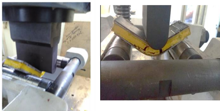
Gambar 3. 19 Pengujian Lentur Pada Material Sandwich Panel
