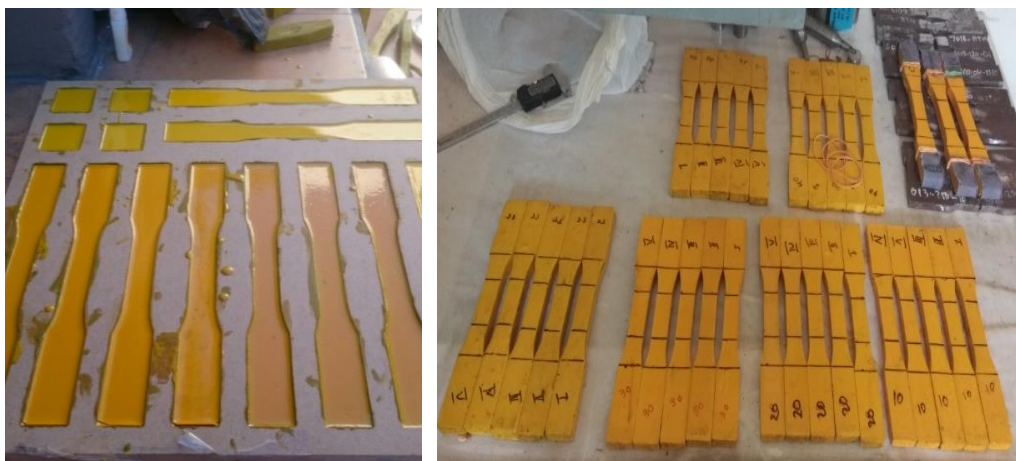
Gambar 3. 7 Gambar (a) Proses Pencampuran Adonan, (b) Proses Penuangan, (c) Proses Pengeringan, (d) Spesimen Uji Core Sandwich
