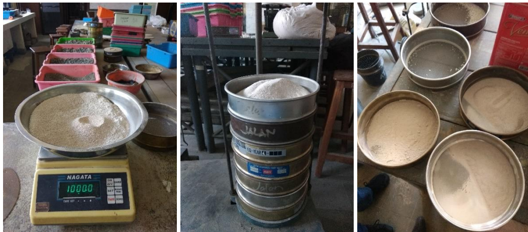
Gambar 4. 1 Proses Identifikasi Size Partikel Serbuk Cangkang Telur
