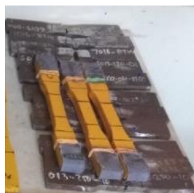
Gambar 4. 8 Penambahan Kertas Gosok pada Ujung Spesimen Uji Tarik
