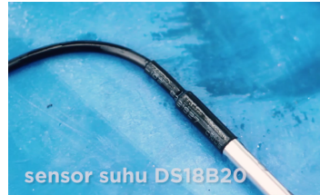
(b) Pemasangan sensor DS18B20
