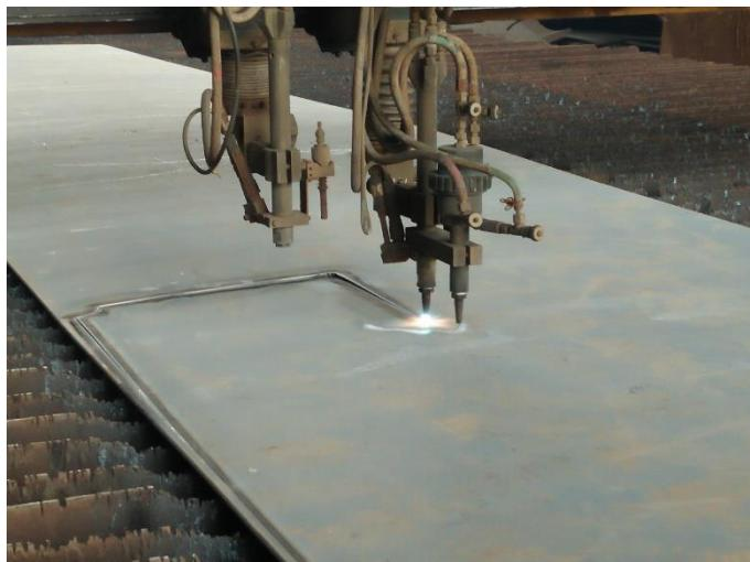
Gambar 2.2 Proses *cutting* menggunakan *NC gas*
