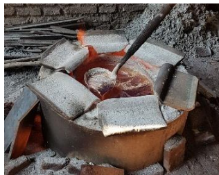
Gambar 3.24 Proses Logam Cair Pada Saat akan Dituangkan kedalam cetakan
