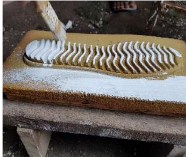
Gambar 3.14 Proses Coating pada Cetakan
