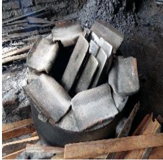
Gambar 3.18 Tanur Sederhana yang Digunakan pada Proses Peleburan Logam Cair
