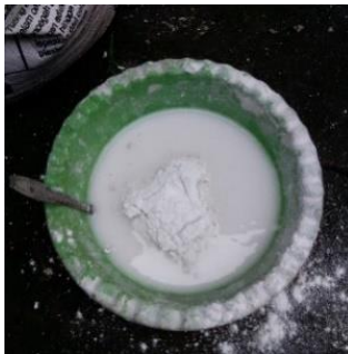
Gambar 3.6 Proses Pencampuran gipsium dengan air
