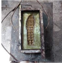
Gambar 3.31 Kerangka Cetakan Pada Penggipsuman Moving Plate
