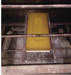
Gambar 3.12 Proses Pemanasan Pasir Resin
