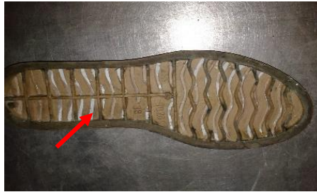
Gambar 4.5 Gypsum Yang Patah Pada Saat Proses Pelepasan.
