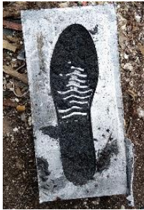
Gambar 3.27 Proses Pembongkaran Cetakan
