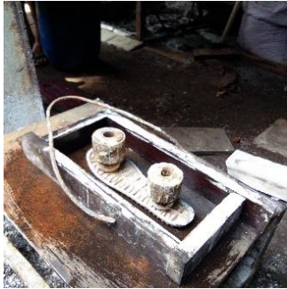
Gambar 3.5 Kerangka Cetak Gypsum
