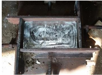
Gambar 3.25 Logam Cair yang Telah Dituang ke dalam Cetakan
