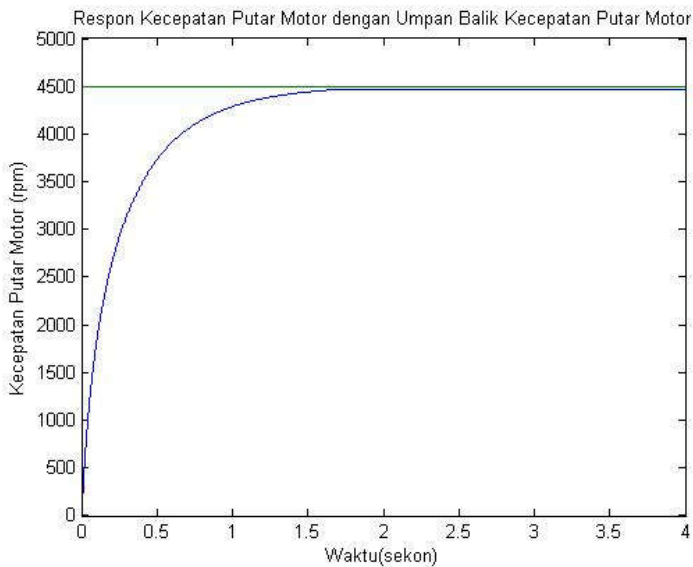
Gambar 4.8 Respon sistem dengan umpan balik kecepatan putar motor
