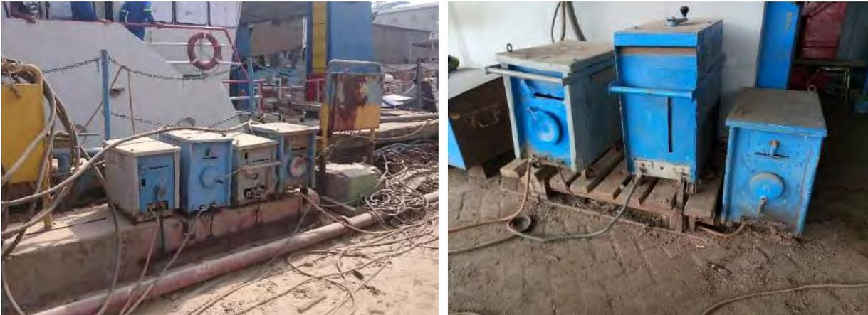
Gambar 4.10 Travo las yang terpasang di samping dok (kiri) dan di bengkel (kanan)
