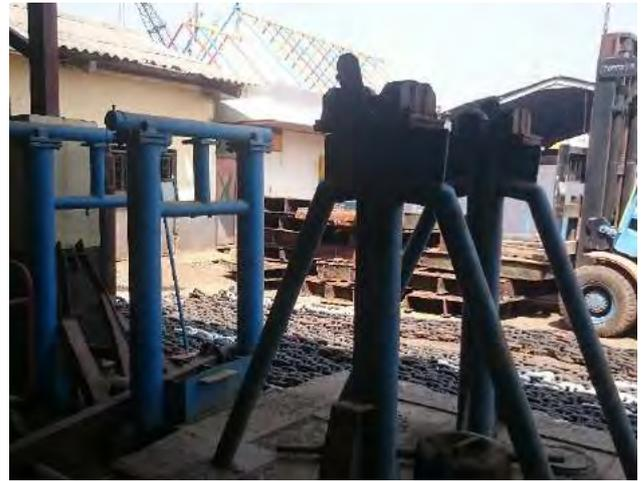
Gambar 4.16 Proses reparasi rantai dan jangkar kapal (kiri) dan dudukan *balancing propeller* (kanan)
